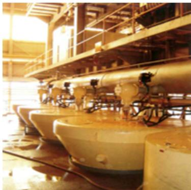
Fabricadas a partir de um processo especial de perfuração cônica por eletroformação, que impede a obstrução dos furos e maximiza a sua produtividade, a linha de telas para Centrífugas Contínuas Permetal oferece o melhor custo / benefício do mercado.
